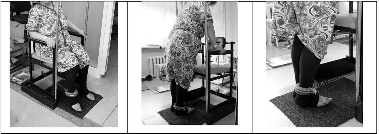
Рис. 10. Процесс измерения силы мышц бедра с помощью динамометра
