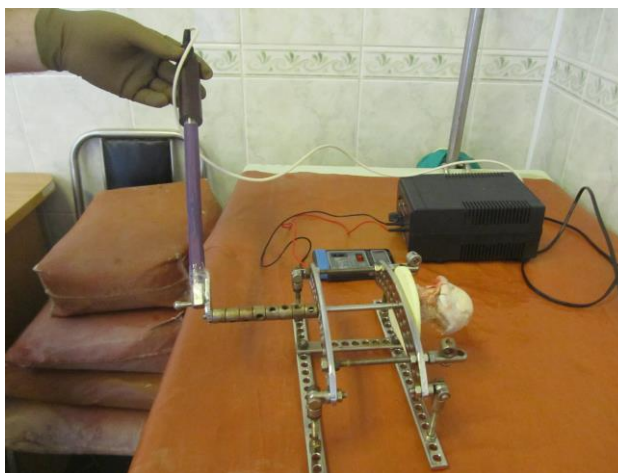
Рис. 3.3 Фото устройства для проведения биомеханического исследования жесткости фиксации компрессирующего стержня в распиле головки бедренной кости
