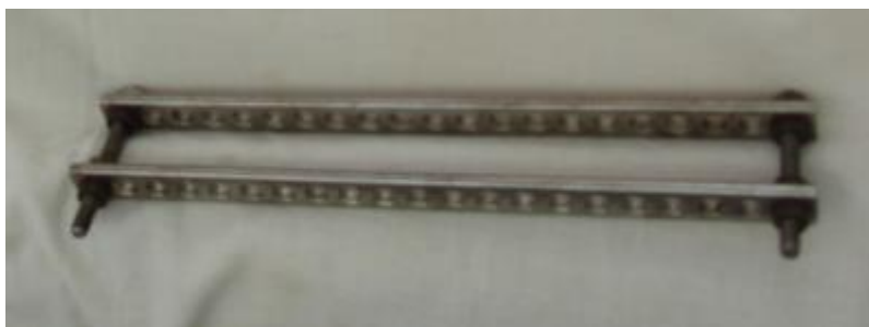
Рисунок 4.8 Фото направителя для установки дистального стержня – шурупа, собранного из деталей аппарата Илизарова
