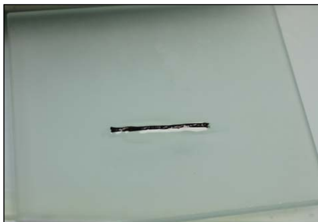
Рис. 45. Нанесение адгезива на углеродное волокно.
