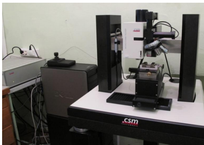
Рисунок 2.21 - Установка Micro-combi tester (CSM Instruments SA, Швейцария) для исследования физико-механических свойств образцов
