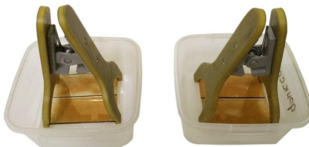
Рисунок 2.39 - Щипцы-зажимы для обработки голографических фотопластинок
