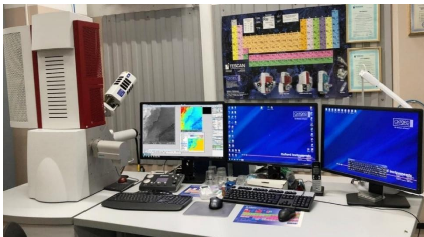
Рисунок 2.15 - Изучение ультраструктуры эмали при увеличении 54000 на микроскопе TESCAN MIRA3 XMH (лаборатория авиационного предприятия АО «ОДК-СТАР»)
