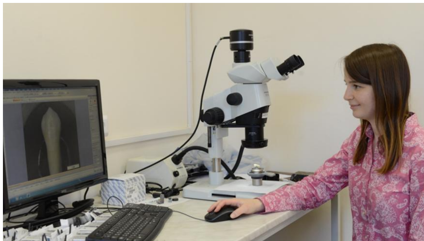
Рисунок 2.14 - Изучение структуры поверхности экспериментального образца на стереомикроскопе Olympus SZX-16 (лаборатория фундаментальных исследований в материаловедении ПНИПУ)
