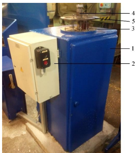
Рисунок 2.26 – Установка СО-8105 для ЭЦИ на осевое сжатие (авиационное предприятие АО «ОДК-СТАР») (1 – шкаф; 2 – пульт управления; 3 – диск с гнездами; 4 – центральный шток; 5 – диск, закрепленный на штоке с гнездами)
