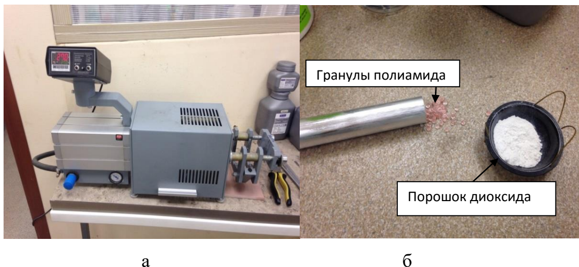
Рисунок 8 — Оборудование для проведения экспериментального этапа исследования: а — аппарат для термолитьевого прессования; б — подготовка картриджа с термопластом, взвешивание компонентов
