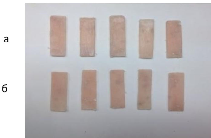
Рисунок 10 — Образцы из полиамида Vertex ThermoSens, армированные наноразмерным диоксидом титана: а) 5 мас.%; б) 10 мас.%
