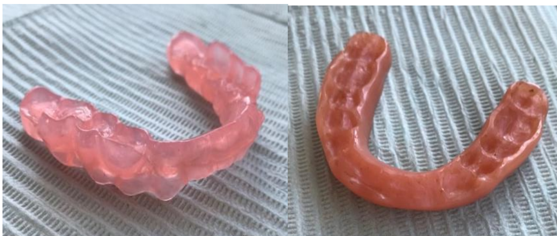
Рисунок 35 – Состояние капы через 6 месяцев пользования: а - капа из полиамида Vertex ThermoSens; б - капа из акриловой пластмассы Фторакс
