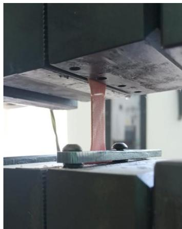
Рисунок 2 — Образец материала *Trinia* при испытаниях на растяжение
