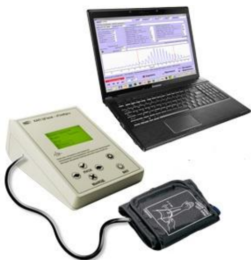
Рис.1. Комплекс аппаратно-программный неинвазивного исследования центральной гемодинамики методом объемной компрессионной осциллометрии "Глобус".
