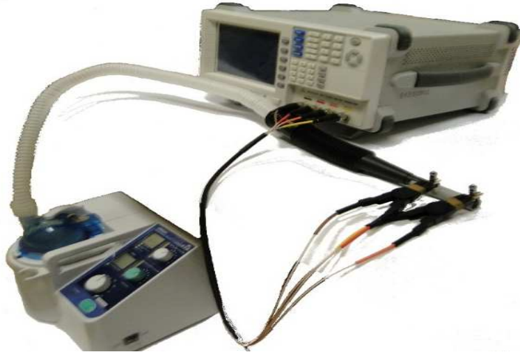
Рисунок 7. RCL-метр GW-Instek 78105G вместе с ультразвуковым небулайзерным ингалятором Omron UltraAir NE-U17-E и измерительной камерой
