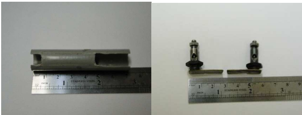
Рисунок 8. Изображение измерительной камеры для экспериментальных исследований электроимпедансных свойств аэрозолей хлорида натрия.
