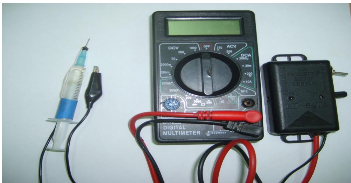
Рис.8. Общий вид аппарата для определения электропроводности на границе сред «эмаль-пломба».
