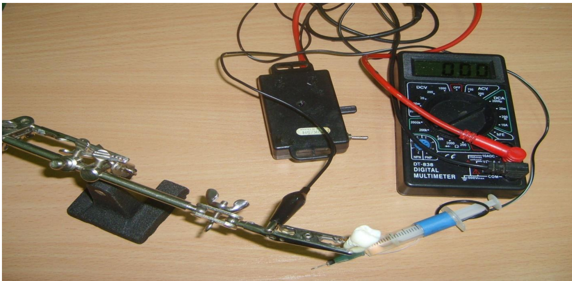
Рис. 3. Общий вид аппарата для определения электропроводности на границе сред «эмаль-пломба» in vitro.
