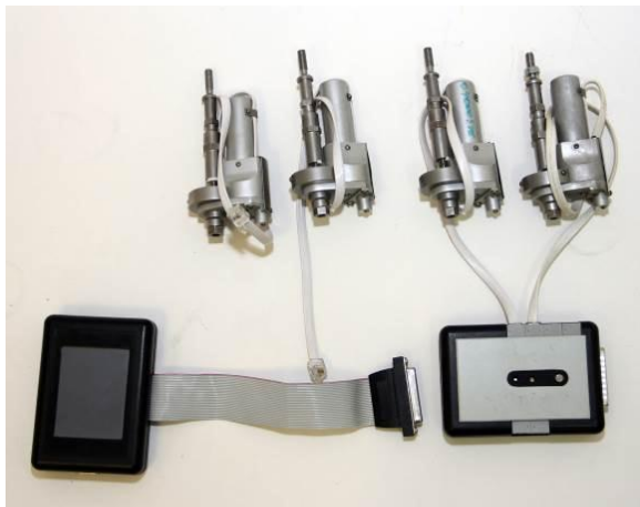
Рис. 15. Аппаратно-программный комплекс для автоматического управления аппаратом Илизарова
