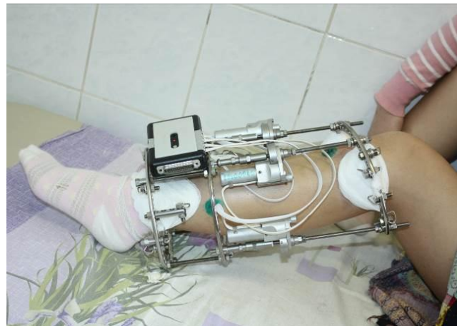
Рис. 15. Аппаратно-программный комплекс для автоматического управления аппаратом Илизарова
