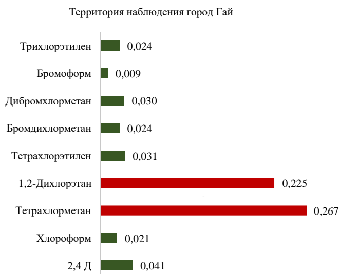
Рисунок 1 – Концентрации хлорорганических соединений в питьевой воде (доля ПДК), территория наблюдения город Гай
