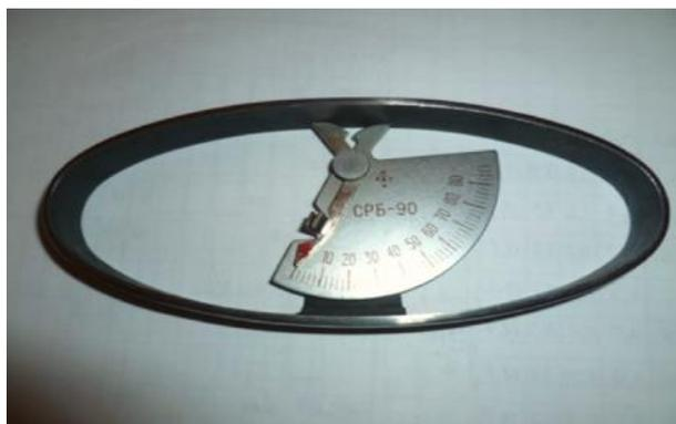
Рисунок 2 – Ручной динамометр
