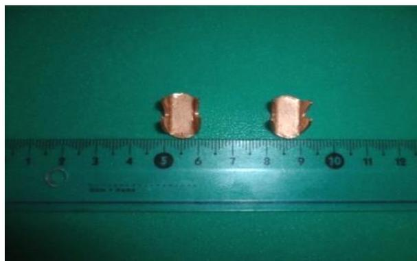
Рисунок 12 – Скрепка-фиксатор
